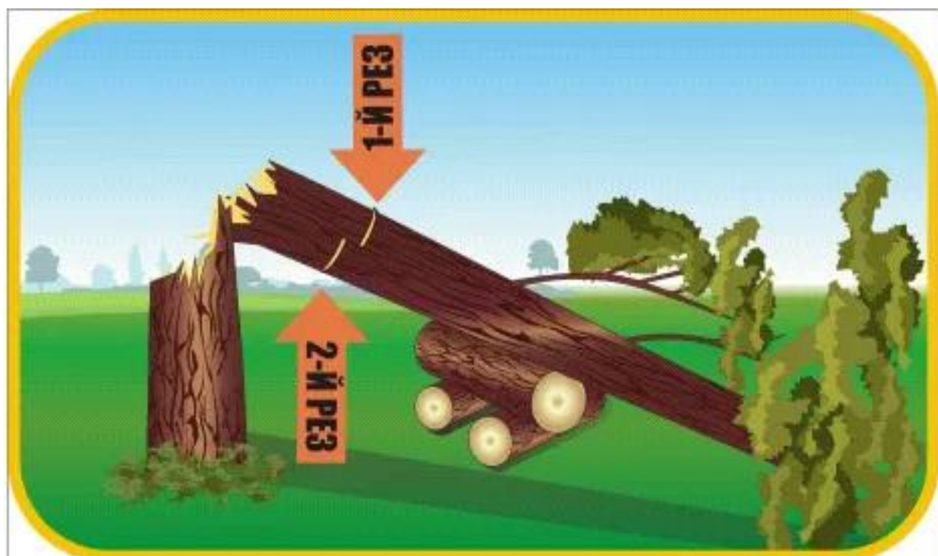
СХЕМА ВАЛКИ ДЕРЕВА С НЕОТДЕЛИВШИМСЯ СЛОМОМ ВЫСОТОЙ МЕНЕЕ 1 МЕТРА
