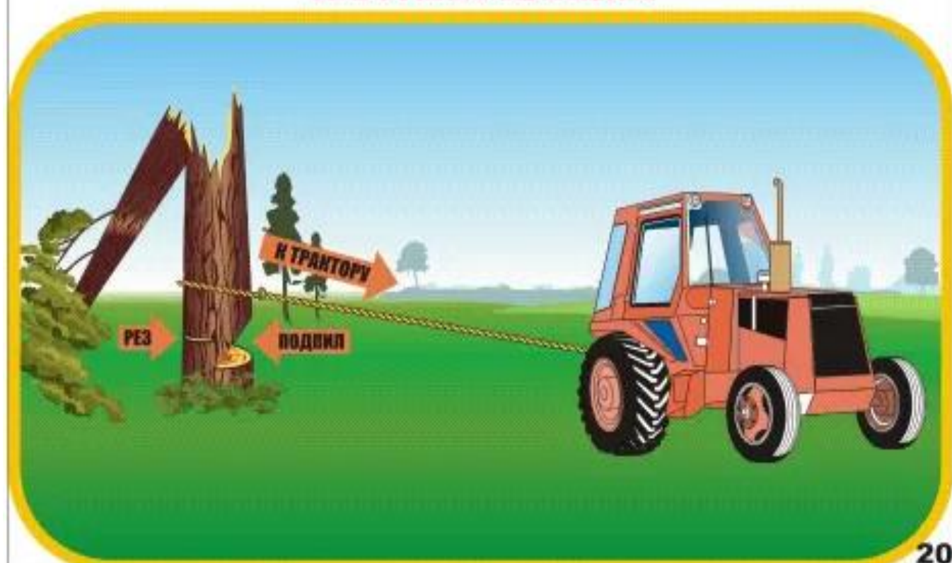
СХЕМА ВАЛКИ ДЕРЕВА С НЕОТДЕЛИВШИМСЯ СЛОМОМ ВЫСОТОЙ БОЛЕЕ 1 МЕТРА
